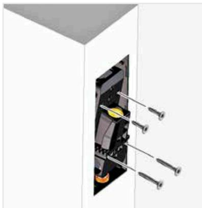
Mit je 2x Ø 4 x 20 mm bzw. Ø 4 x 40 mm Fixierschrauben auf Toleranzgitter sichern
