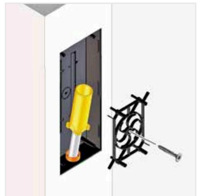
Toleranzgitter einstecken und mittig fixieren mit Schraube  $\varnothing 3 \times 20$  mm
